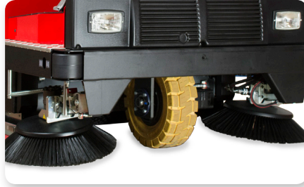
Kit spazzante spazzola destra e/o sinistra Sweeping side brush kit right and/or left
